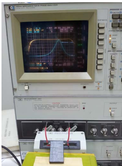
Слика 5. Мерење електричних параметара трансформатора помоћу Impedance Analyzer HP4194А.
